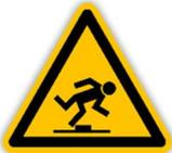
**¡Peligro de tropiezo!** Al tender y colocar el cable de carga fuera de la caja de la batería, deben respetarse siempre todas las indicaciones de seguridad. Existe riesgo de tropiezo debido a cables tendidos o rotulados incorrectamente. Peligro de lesiones leves o graves.
