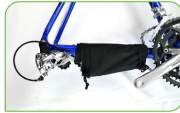
Wickle den Schutz mit dem gepolsterten Bereich einmal um die Kettenstrebe und befestige ihn mit den ersten Klettstreifen. Anschließend spanne das Schaltauge nach vorne und fixiere es mit dem seitlichen kleinen Gurt. Danach sammle die Kette so weit wie möglich und lege sie gemeinsam mit dem Schaltauge in den Schutz. Klappe diesen um und befestige ihn sicher. Zum Abschluss ziehe die Kordeln straff, um die Kette und das Schaltauge zuverlässig zu sichern.
