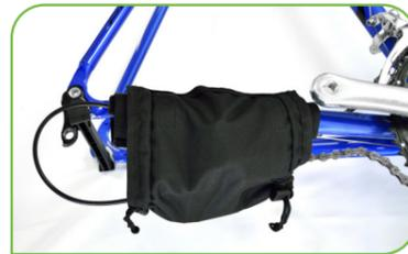
Wickle den Schutz mit dem gepolsterten Bereich einmal um die Kettenstrebe und befestige ihn mit den ersten Klettstreifen. Schraube anschließend das Schaltwerk ab und lege es zusammen mit der Kette in den Schutz. Danach klappst du den Schutz um und fixierst ihn mit dem Klettverschluss. Zum Schluss ziehst du die Kordeln straff, um das Schaltwerk und die Kette sicher zu fixieren.
