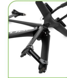
Befestige die TPE-Teile am Distance Keeper, ziehe ihn auf die gewünschte Länge heraus und arretiere ihn durch Drehen. Setze den Distance Keeper anschließend zwischen der Achse ein und befestige ihn sicher.
