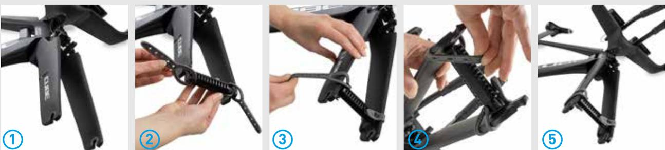
Die TPE-Teile an dem Distance Keeper befestigen, diesen dann auf die benötigte Länge ausziehen und durch drehen verriegeln. Nun den Distance Keeper zwischen der Achse positionieren und befestigen. | Attach the TPE parts to the Distance Keeper, then pull it out to the required length and lock it by turning it. Now position the Distance Keeper between the axle and fasten it.
