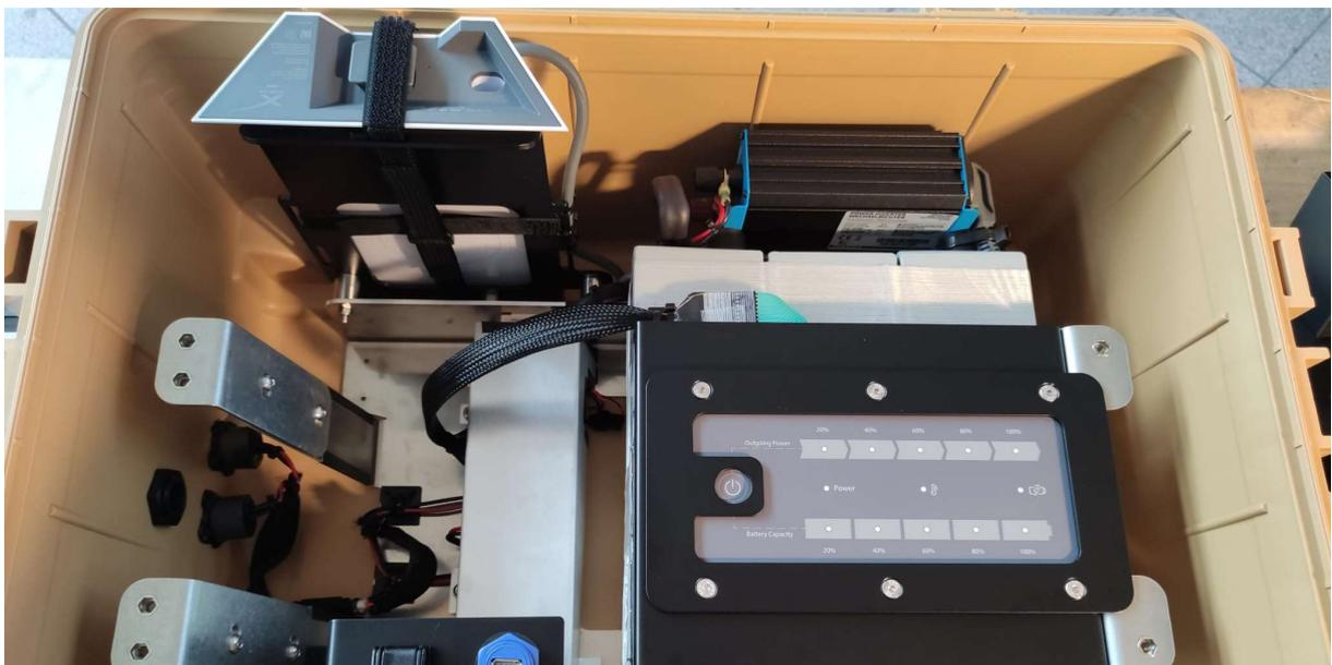
En el siguiente paso se puede volver a colocar la tapa. Tenga especial cuidado al atornillar los tornillos. Los tornillos no deben atascarse. Se recomienda apretar los tornillos sólo con la mano. Consejo: La llave Allen insertada en el tornillo puede utilizarse para presionar fácilmente la rosca del soporte bajo la tapa hasta la posición deseada.
