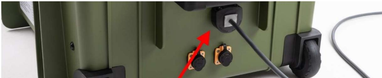
Por último, el cable debe introducirse correctamente en el aparato: el cable sale de la posición (1) y debe enchufarse en la posición (2) del router Starlink. A continuación, se puede pulsar el interruptor principal (4) para iniciar el sistema. Sólo entonces se aplicará corriente a la toma y a los puertos USB. Precaución: ¡El cable no debe quedar atrapado accidentalmente entre la tapa y la carcasa en la posición (3)!
