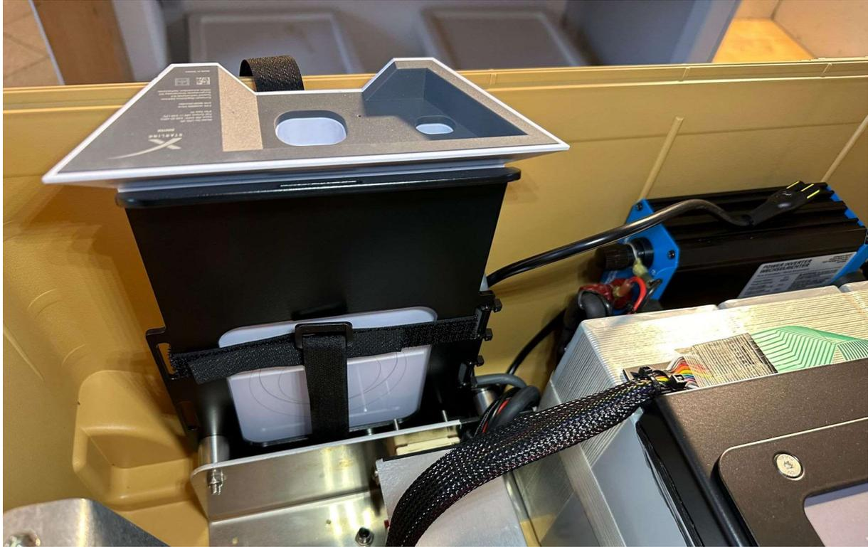
A continuación, enchufe firmemente el cable de alimentación preinstalado en el router Starlink y asegure el cable enchufado con la cinta de velcro horizontal. Debe prestarse especial atención a que la cinta de velcro pase por encima del cable insertado y se apriete con cuidado. Las siguientes ilustraciones muestran el procedimiento y la posición exacta de las correas de velcro después de la instalación.
