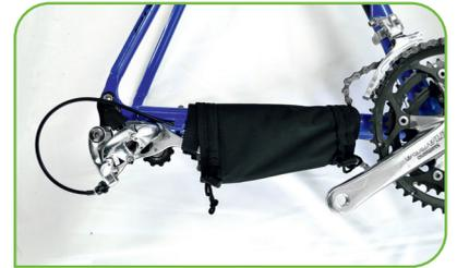
Wickle den Schutz mit dem gepolsterten Bereich einmal um die Kettenstrebe und befestige ihn mit den ersten Klettstreifen. Anschließend spanne das Schaltauge nach vorne und fixiere es mit dem seitlichen kleinen Gurt. Danach sammle die Kette so weit wie möglich und lege sie gemeinsam mit dem Schaltauge in den Schutz. Klappe diesen um und befestige ihn sicher. Zum Abschluss ziehe die Kordeln straff, um die Kette und das Schaltauge zuverlässig zu sichern.
