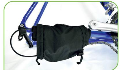
Wickle den Schutz mit dem gepolsterten Bereich einmal um die Kettenstrebe und befestige ihn mit den ersten Klettstreifen. Schraube anschließend das Schaltwerk ab und lege es zusammen mit der Kette in den Schutz. Danach klappst du den Schutz um und fixierst ihn mit dem Klettverschluss. Zum Schluss ziehst du die Kordeln straff, um das Schaltwerk und die Kette sicher zu fixieren.
