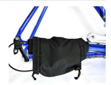
Der Schutz wird mit dem gepolsterten Bereich ein Mal um die Kettenstrebe gewickelt und mit den ersten Klettstreifen befestiat.
